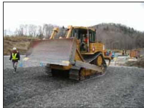
写真-1 クローラによる破碎走行
