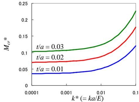
図-4 座屈時の曲げモーメント ( $a/L=0.1$ )
