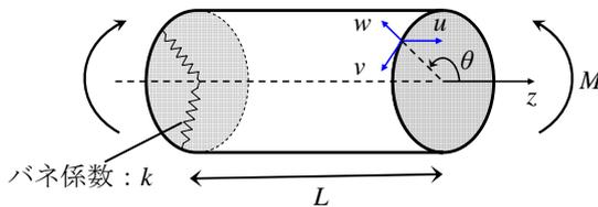
図-1 解析対象とするチューブ構造
