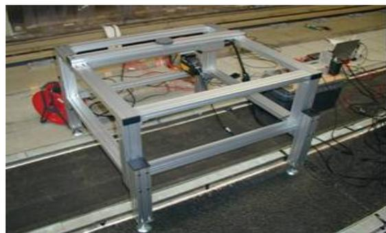
写真-4 定置式の路面テクスチャ装置
