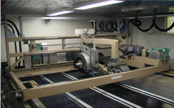
写真-5 恒温室内の走行試験装置
