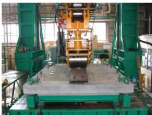
写真-1 輪荷重走行試験機（鉄輪）
