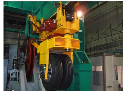
写真-2 輪荷重走行試験機（ゴムタイヤ）
