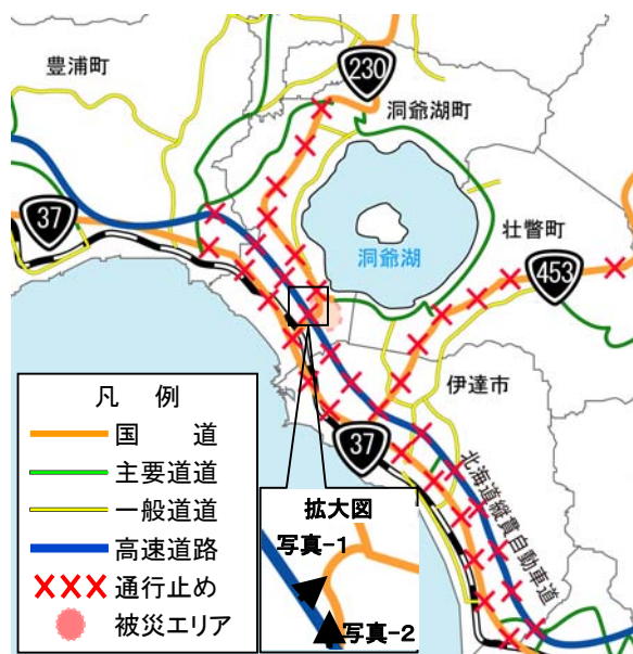
図-1 周辺道路網の通行止め状況
