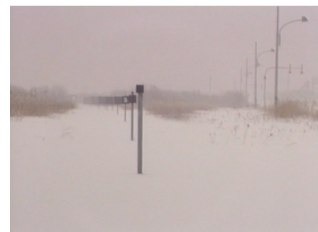
写真2 吹雪時における視程板の映像
