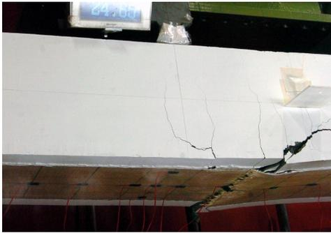
(b) P20 試験体(シート破断後)
