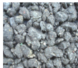
図-2. 透水性アスファルト
