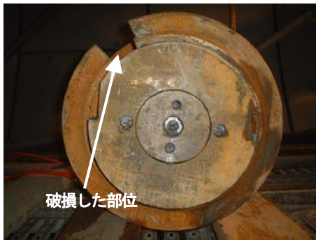
写真-5 ディスクカッタ破損状況
