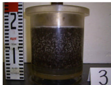
写真-2 凍上試験の試験状況
