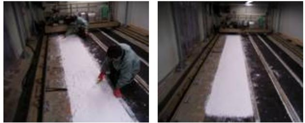
写真-7 軟圧雪路面作製状況 (左) と圧雪路面 (右)
