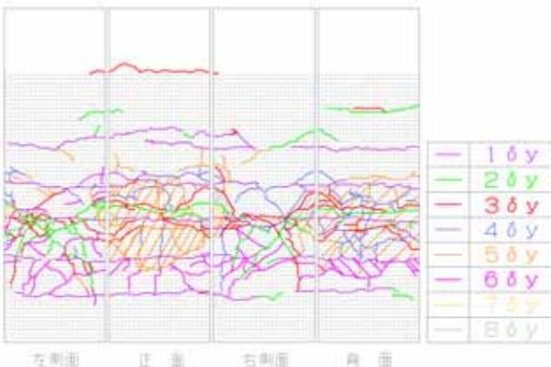
図 3.6 CASE-3 供試体ひび割れ図
