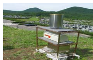
(b)雨量計設置状況
