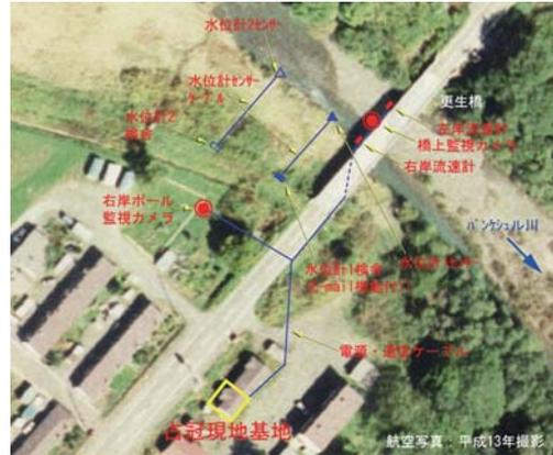
図-1 観測所の機器配置
