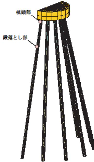
図 - 8 杭体応力度波形算出位置
