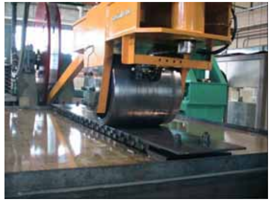
写真 - 2 完全水没下における輪荷重試験
