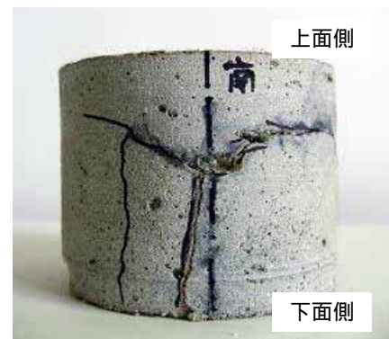
写真 - 3 輪荷重走行試験後のコア側面
