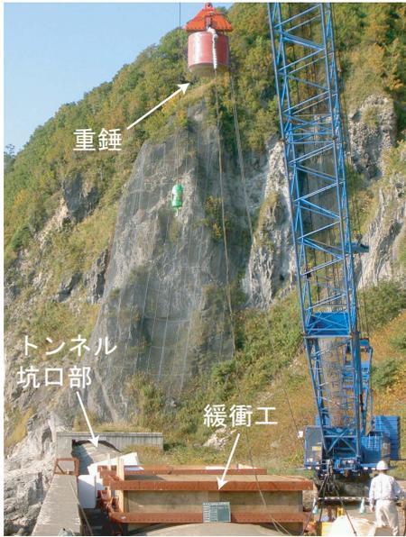
写真-2 実験状況
