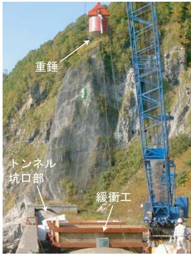
写真 - 2 実験状況
