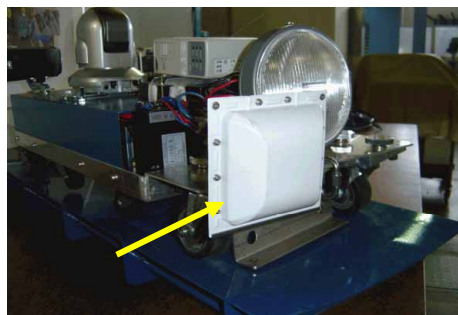
写真－7 無線用アンテナ
