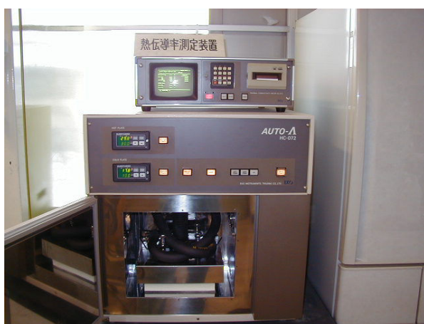
写真.2 熱伝導率試験状況
