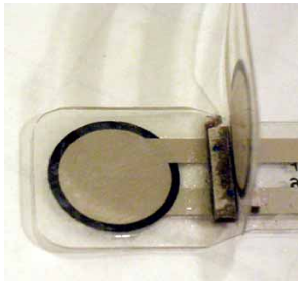
写真1 直交方向に配置した土圧計
