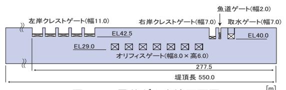
図-2 二風谷ダム上流正面図 [m]
