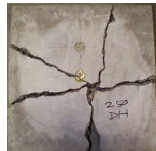
図-6 実験終了後のコンクリート板のひび割れ分布状況
