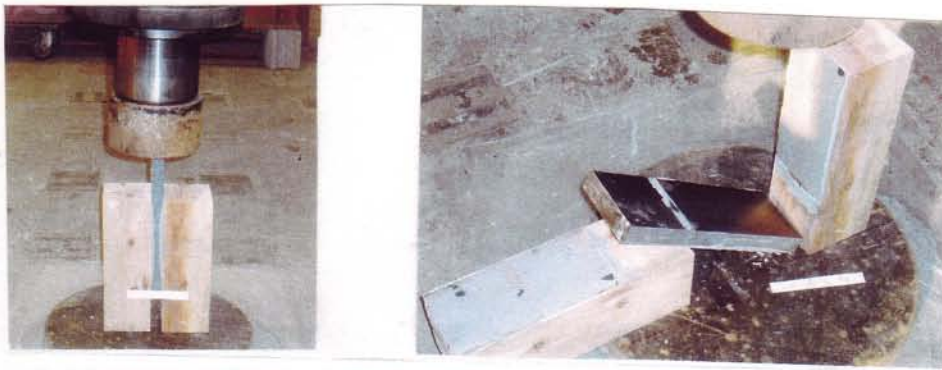
写真-6 試験体No. A1 黒皮つき鋼板 P=1.5t 黒皮が鋼板表面より剥がれた
