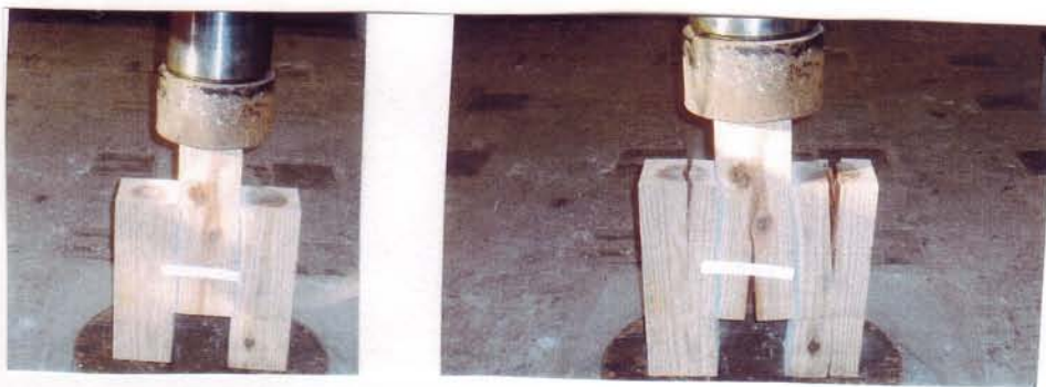
写真-7 試験体No. B1 磨かない杉材 P=20.0t 木材がせん断
