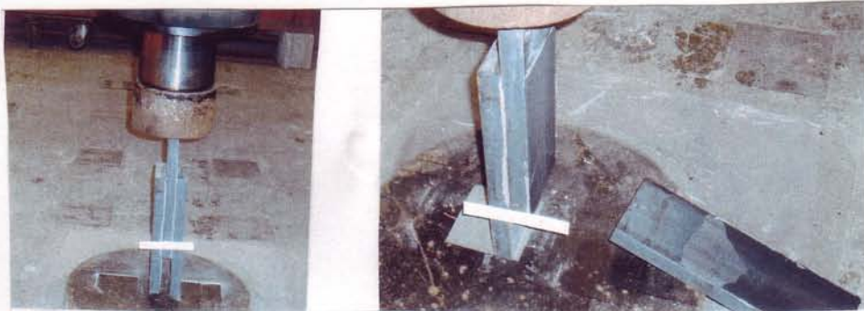
写真-8 試験体No. C1 黒皮つき鋼板 P=10.5t 黒皮が鋼板表面より剥がれた
