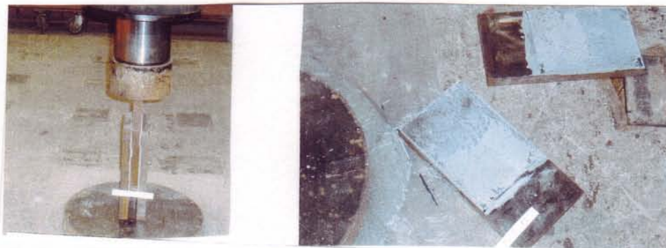
写真-9 試験体No. D1 黒皮を磨いた鋼板 P=59.8t 接着剤自身がせん断
