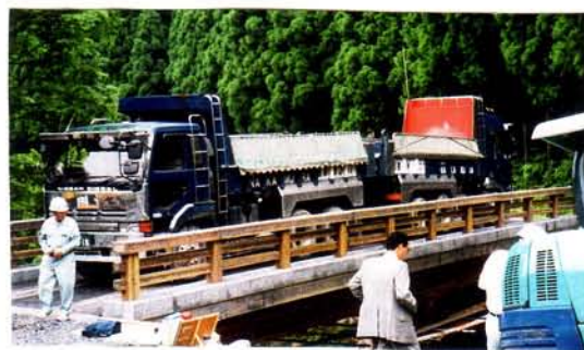
写真-5 「竜谷杉橋」の載荷実験(20トントラック2台)
