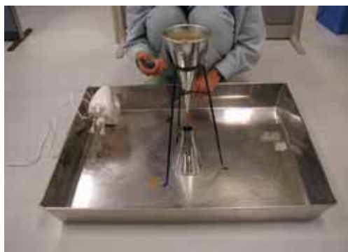
図 - 4 ファンネル粘性試験
