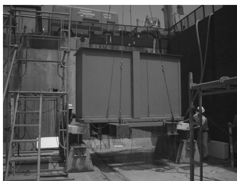
写真-4 水槽衝撃載荷実験状況
