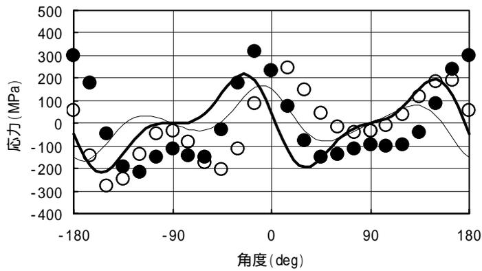
図-8 面外曲げ扁平量からの応力推定結果
