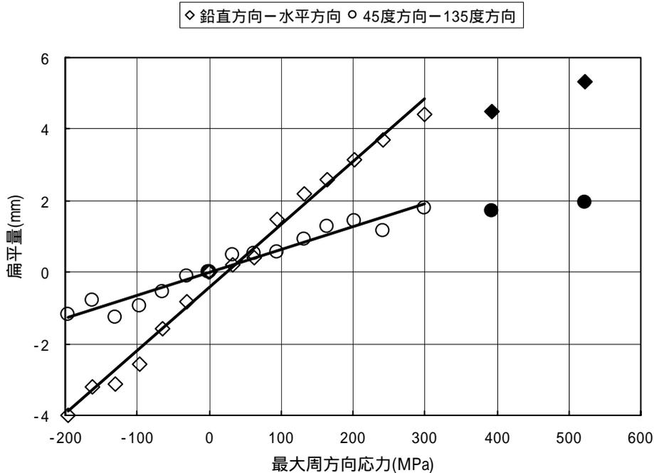
図-6 外径変化量と最大応力との関係
