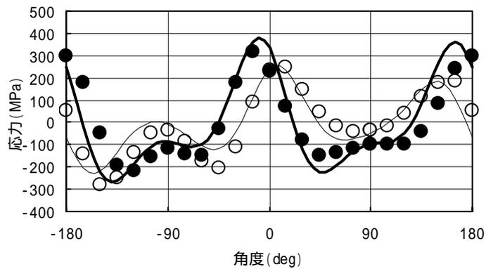
図-9 面内および面外曲げ扁平量からの応力推定結果
