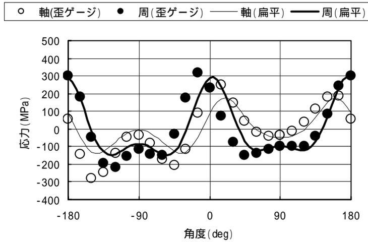
図-7 面内曲げ扁平量からの応力推定結果
