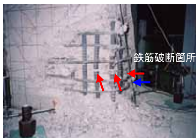
写真1 載荷終了時の鉄筋破断状況
