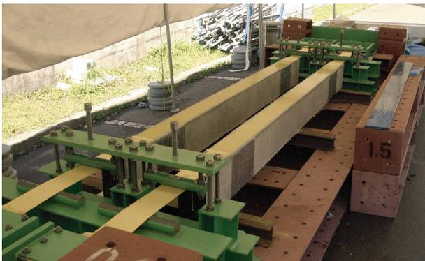
写真-1 緊張接着時の養生状況
