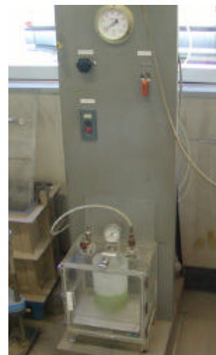
写真3 真空脱泡装置 全景
