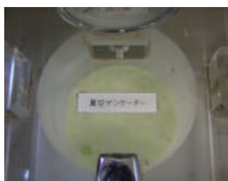
写真2 脱泡注入状況
