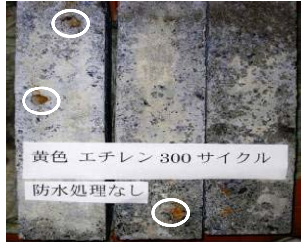
写真-4 ポップアウト現象が発生した供試体②
