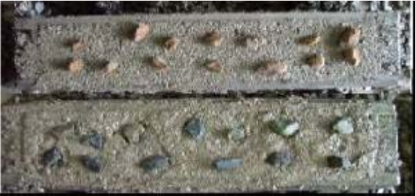
写真-1 骨材の配置位置 (上:黄色 下:灰色)
