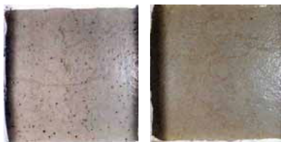
写真-1 浸漬前後の表面状況 (BB50、打設面)
