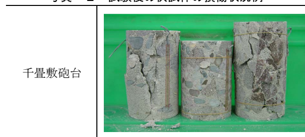
写真－2 試験後の供試体の損傷状況例
