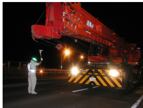
写真-1 荷重車走行試験
