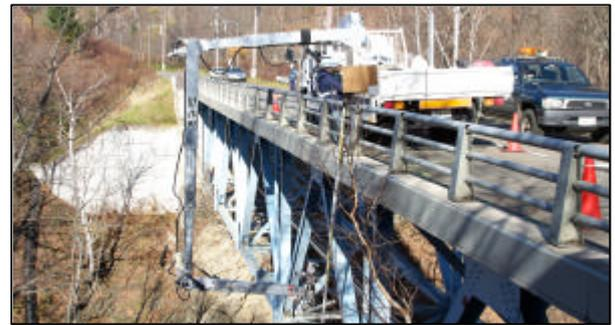
写真-1 簡易型橋梁点検車
