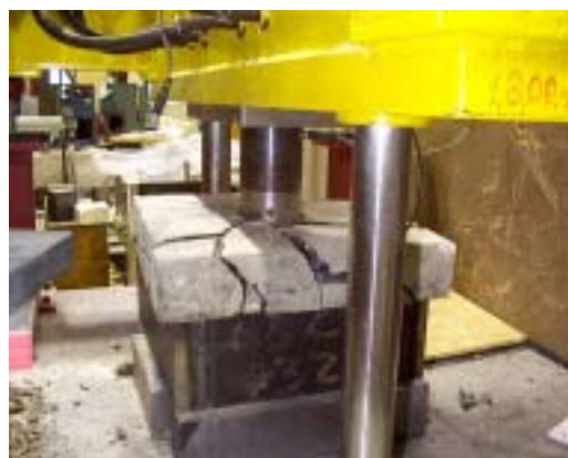
写真-1 衝撃荷重を受ける四辺 単純支持されたコンクリート床板
