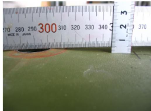
写真 - 2 荷重除荷後の変形
