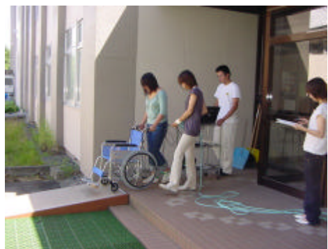
写真-4 空車走行実験風景(スロープ前向き)
