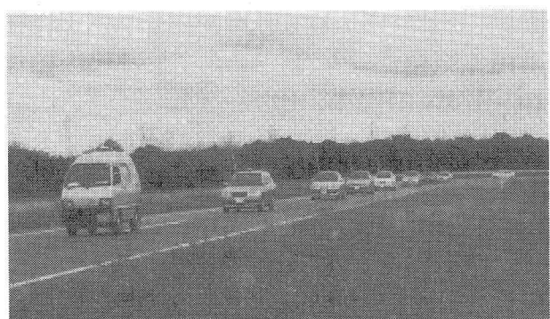
写真-2 追従挙動走行実験・冬期（苫小牧寒地試験道路）
