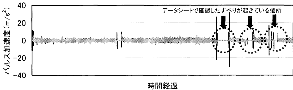
図-7 一般道路でのパルス加速度の変化例
