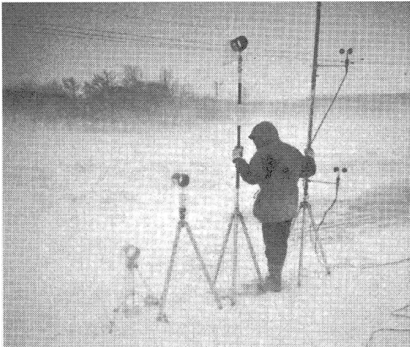
図 2 道路上の飛雪流量観測状況。なお、左端の吹雪計（雪堤の高さ）は今回の解析には用いない。
