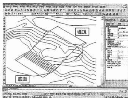
図-5 コンタ図から自動作図した設計図
