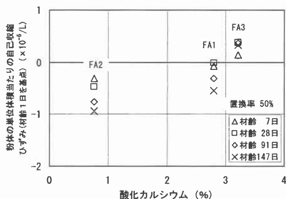
図-8 酸化カルシウムと 粉体の単位体積当たりの自己収縮ひずみ
