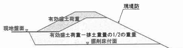
図 3.2 (2) ケース 2 排土重量の 1/2 を減じた荷重 (押え効果①)
