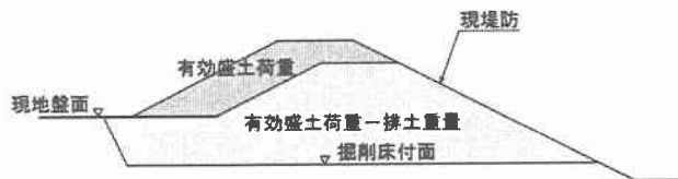
図 3.2 (3) ケース 3 排土重量を減じた荷重 (押え効果②)
