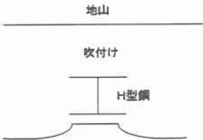
図-1 吹付けコンクリートの変形
