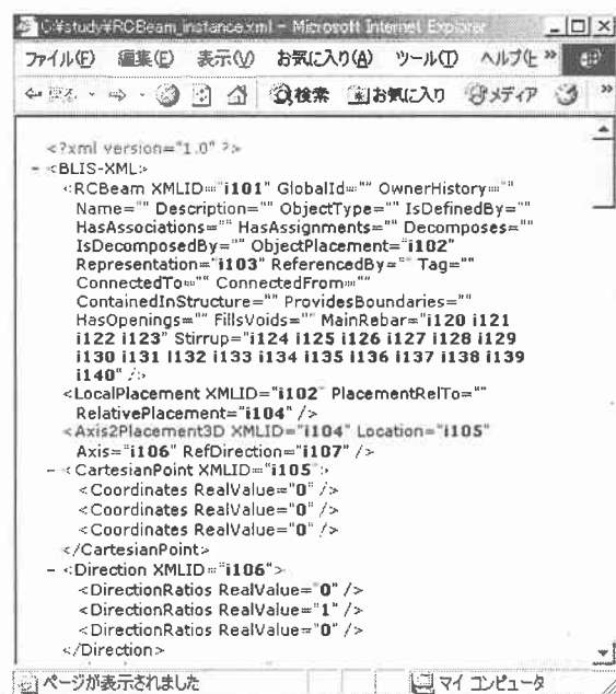
図-6 矩形断面 RC 梁のインスタンス
