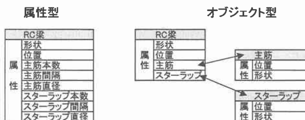
図-4 RC 梁のモデル化手法
