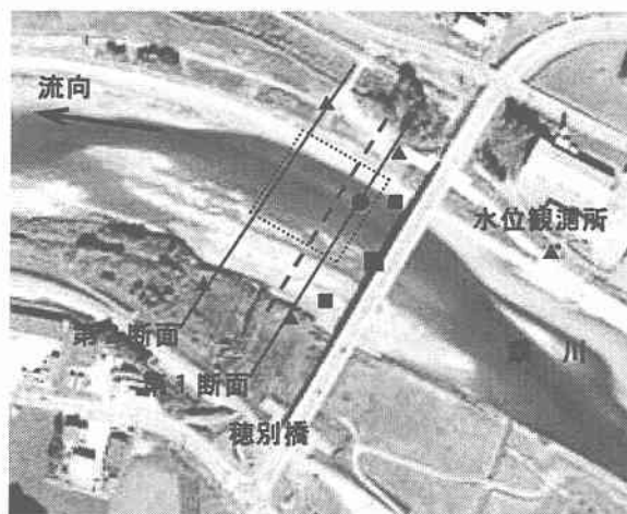
写真-2 観測箇所図(H11年9月撮影。H13年時点では左右岸沿いの二股の流れである。▲:水位計設置箇所、●:定点ADCP流速観測、点線上:横断ADCP流速観測、■:浮遊砂調査箇所、□:河床形状調査箇所)
