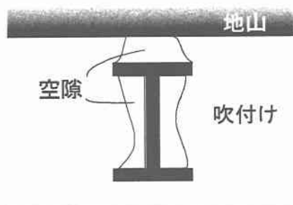
図-2 空隙の状況
