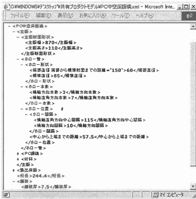
図-4 XML による共有プロダクトモデルデータ
