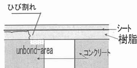
図5 ひび割れの進行図-2
